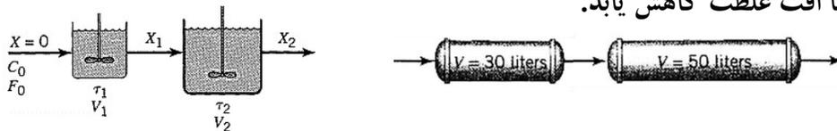
▪ در صورتی که یک راکتور مخلوط شونده و یک راکتور لوله ای داشته باشیم بهتر است راکتور ابتدا راکتور لوله ای قرار گیرد.
